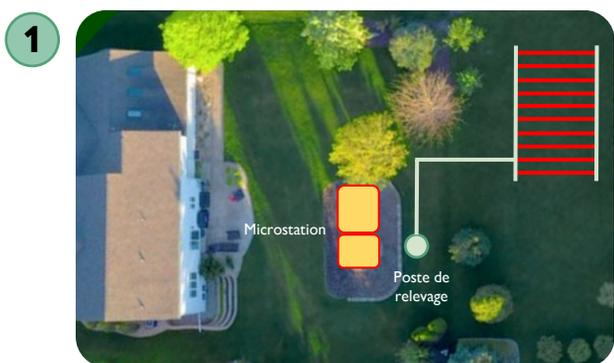
Déterminer au préalable la zone à irriguer et la position du goutte à goutte (rouge) et du tuyau d'alimentation (vert clair)
